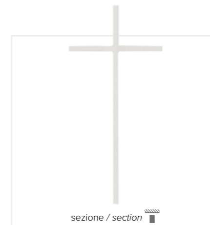
Art. 1760W h. 10 x 5 5 x 10 mm Art. 1761W h. 12 x 7 5,5 x 12 mm Art. 1762W h. 15 x 7 5,5 x 12 mm Art. 1763W h. 20 x 9 6 x 14 mm Art. 1764W h. 25 x 9 6 x 14 mm
